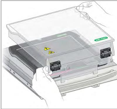
3. Inserte las dos lengüetas de bloqueo que se extienden desde la parte frontal del protector UV en las dos ranuras del cajón del transiluminador.
