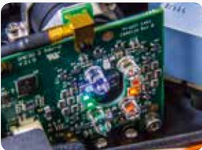
ZE5-EYE:10種類のLEDがすべての光路を確認します。
