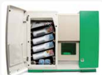
ZE5にはシース液と廃液タンクが2セットあり、1セットが使い終わるといつでもホットスワップ可能です。
