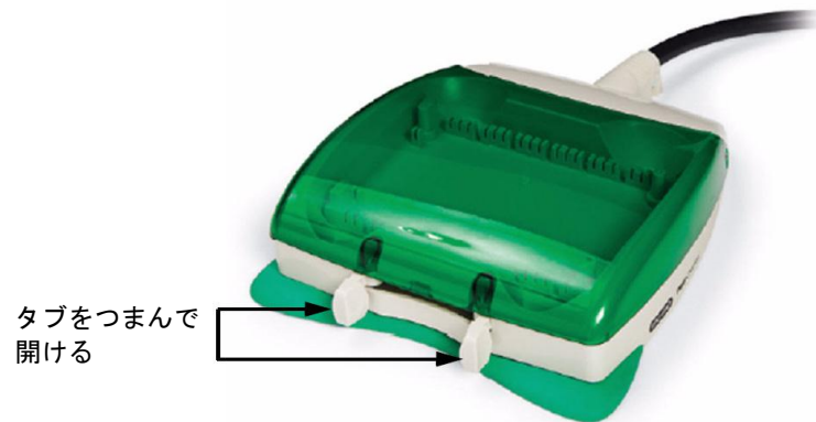
図 4. プレートチャンバーを開ける
