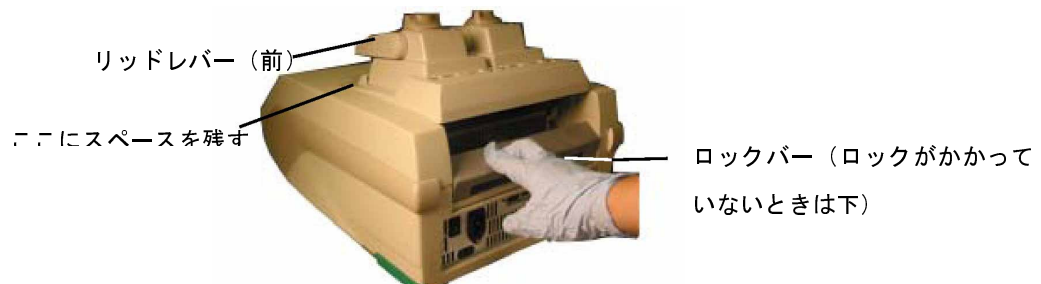
図 4. リアクションモジュールをベイに差し込むところ
