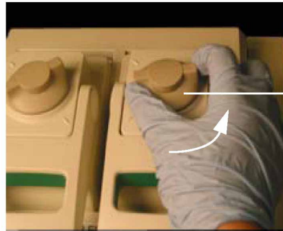
図 6. 内側リッドを解放するためリッドフォースノブを反時計まわりに回す
