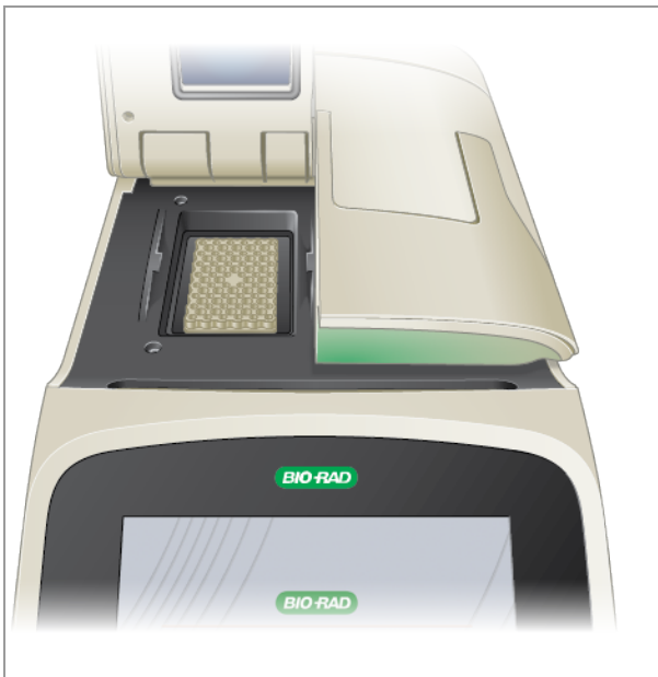
图 10: PTC Tempo 48/48 样品反应模块和热盖
