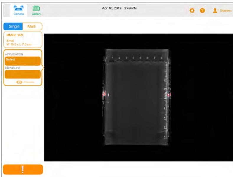
Cuando coloque una muestra en el sistema de imágenes, la vista de cámara mostrará la muestra tal como aparece en la bandeja actual. En el panel izquierdo, puede elegir la configuración de la captura de imágenes, como el tamaño de la imagen, la aplicación y la exposición, para cada canal que desee adquirir.
