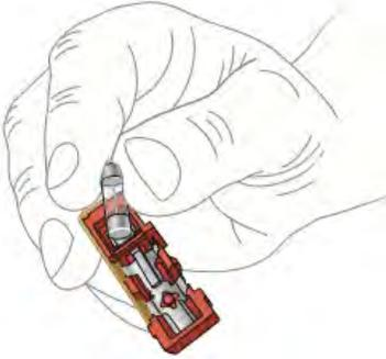
5. Inserte un fusible nuevo y luego vuelva a colocar la caja de fusibles en su ranura.
