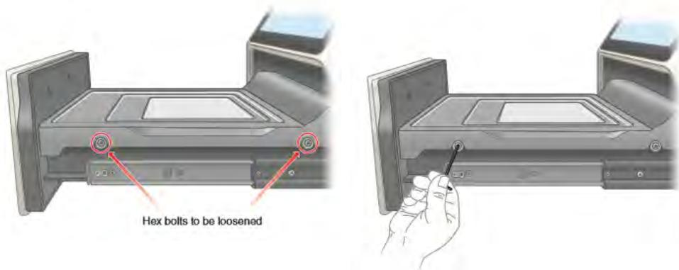
**Consejo:** Deje los tornillos aflojados en los orificios roscados para evitar perderlos.
