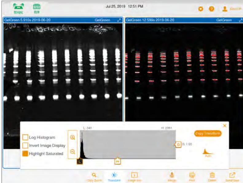
3. Toque Copy Transform (Copiar transformación) en el cuadro de configuración de transformación para copiar la configuración de transformación a las otras imágenes. Copy Transform (Copiar transformación) solo se aplica a las imágenes que son visibles en la pantalla. Los canales que no son visibles no se ven afectados.
