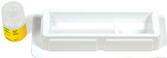
Bac à réactif et huile de production de gouttelettes.
