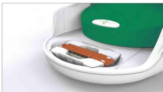
図 2.5 QX200 Droplet Generator の中に設置した DG8 Cartridge
