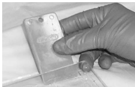
Fig. 3.6A. Open the gel cassette.
