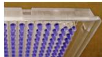
図 11: サーマルサイクル後にサンプルの体積を調べますここに示した例では、コーナー部分のウェルのシーリングが不十分であり、サンプルが蒸発している様子が分かります
