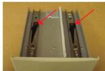
図 15：引き出しの下側 黒色のタブ(矢印)を押すと、トラックから引き出しが外れます
