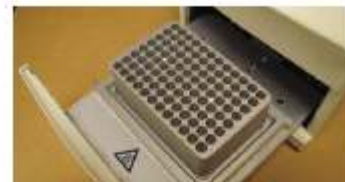
B: 引き出しの中にプレートサポートブロックを入れる
