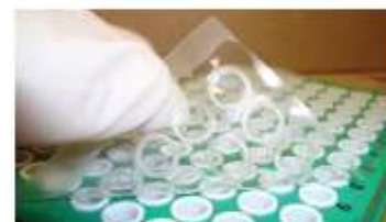
図 10: 均一かつ完全な円形であれば、良好なシーリング状態であることを示しています
