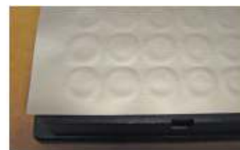
図 9: 個々のウェルの周囲およびプレート全体にわたって、模様が均一でなければなりません
