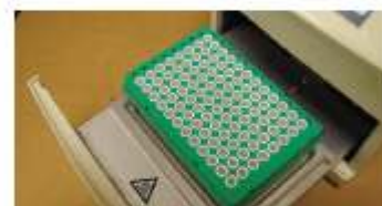
C: プレートサポートブロックに PCR プレートを配置する
