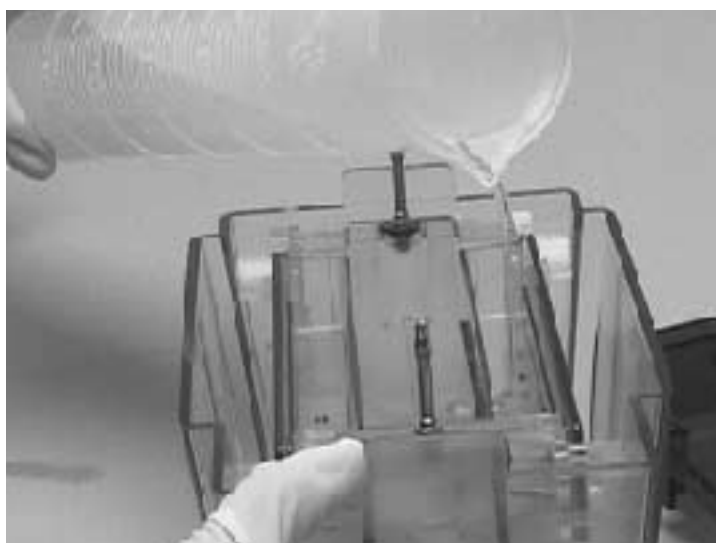
Fig.3 Criterionゲルの上部バッファークラスにバッファークラスを満たします
